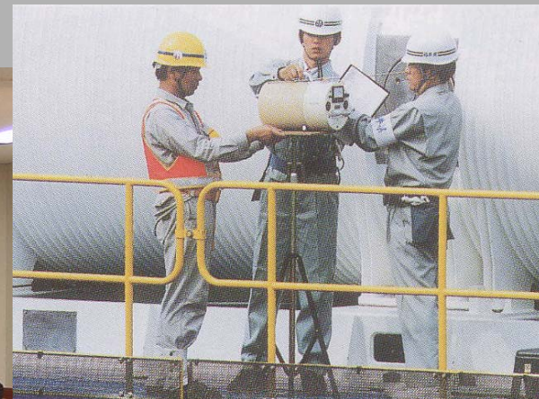
高浜発電所MOX燃料輸送容器 の 放射線量率測定（平成11年）
