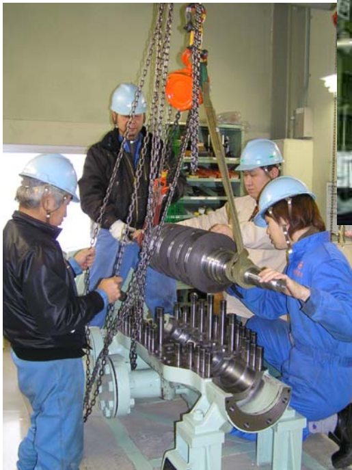
専門研修：ポンプ分解組立て
